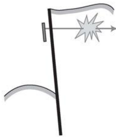
(d) Failure of anchor/prop
